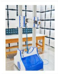
■ 高频俯仰天线塔
