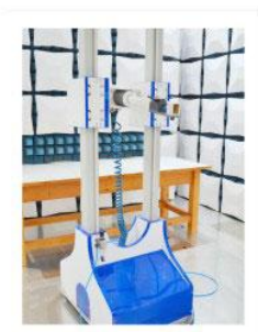
■ 高频俯仰天线塔
