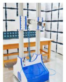
■ 高频俯仰天线塔
