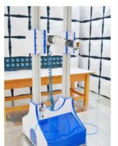
■ 高频俯仰天线塔
